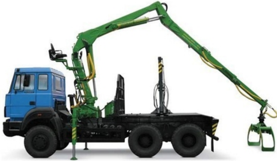
Гидроманипулятор ОМТЛ-120-01 на шасси Урал
